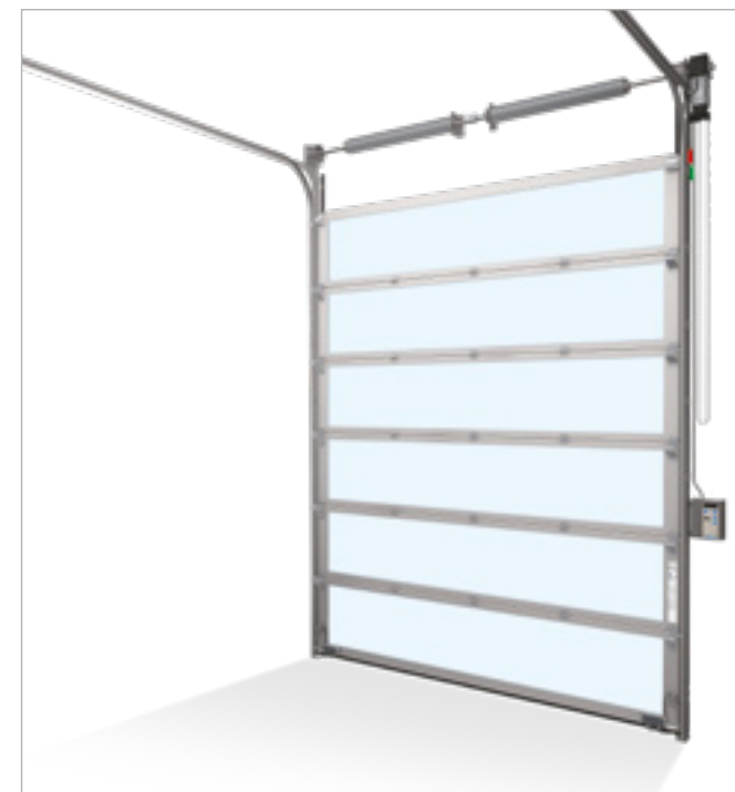
Współczynnik U dla bramy Novolux XL 40: 4.000 x 4.000 mm: 3,87 W/m²K Współczynnik U dla bramy Novolux XL 60: 4.000 x 4.000 mm: 2,43 W/m²K
