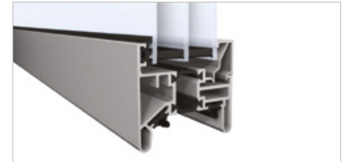
Potrójna szyba z Pleksiglas Optical 40 mm (4-14,75-2,5-14,75-4 mm)
